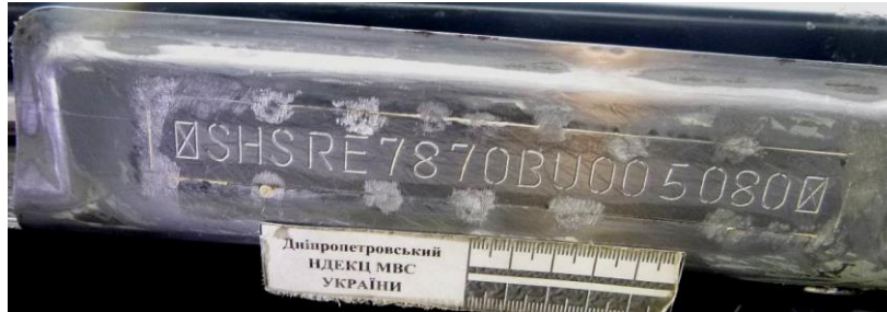
Рис. 2.1. Зміна шляхом припаювання фрагменту номерної пластини.
