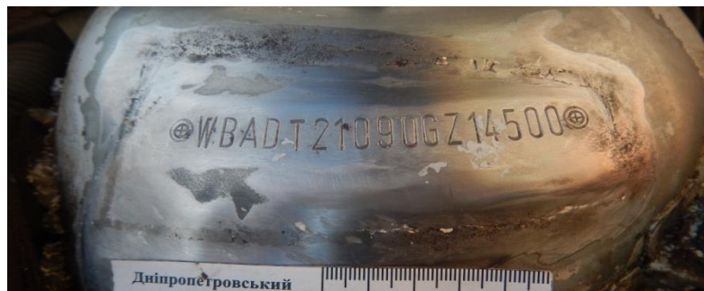
Рис. 2.2. Зміна шляхом вварювання фрагменту номерної пластини.
