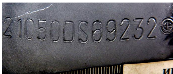
Рис. 1.1. Зміна (перебивання) окремих знаків в номері кузова.
