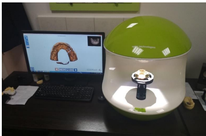
Рис. 1. Оптичний 3d сканер NeWay компанії Open Technologies.
