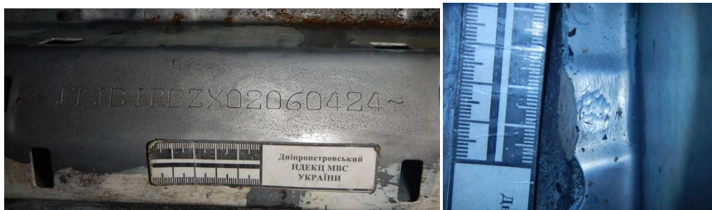
Рис. 3.2. Зміна шляхом уварювання цілої номерної панелі з іншого аналогічного автомобіля.
