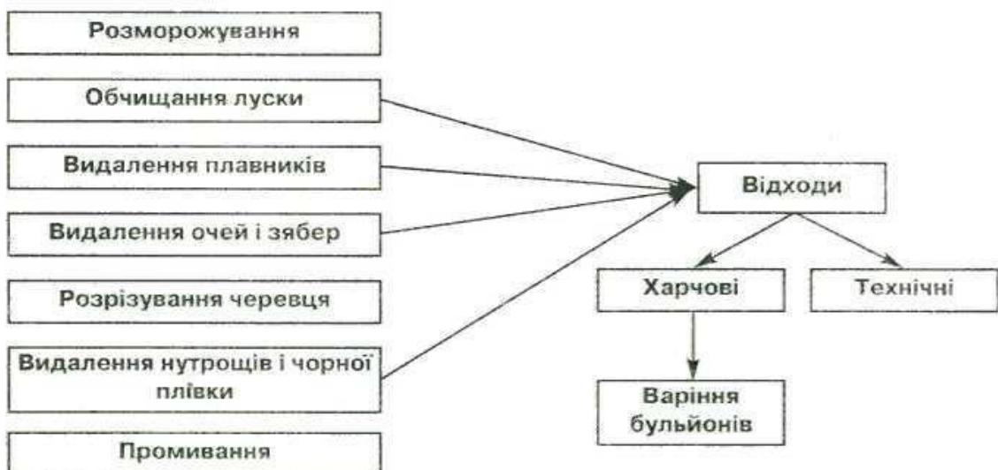
Рис.2 Технологічна схема обробки риби
