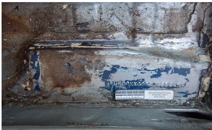
Рис. 3.1. Зміна шляхом уварювання цілої номерної панелі з іншого аналогічного автомобіля.
