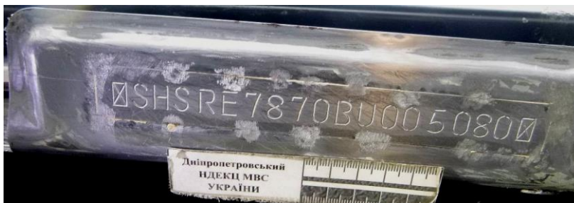
Рис. 2.1. Зміна шляхом припаювання фрагменту номерної пластини.
