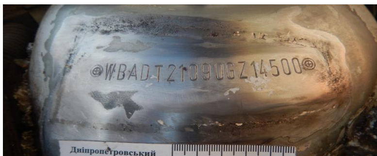
Рис. 2.2. Зміна шляхом вварювання фрагменту номерної пластини.
