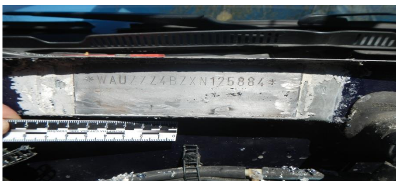
Рис. 2.3 Зміна шляхом приклеювання фрагменту номерної пластини.
