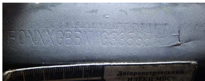
Рис. 1.2. Зміна (перебивання) всіх знаків в номері кузова
