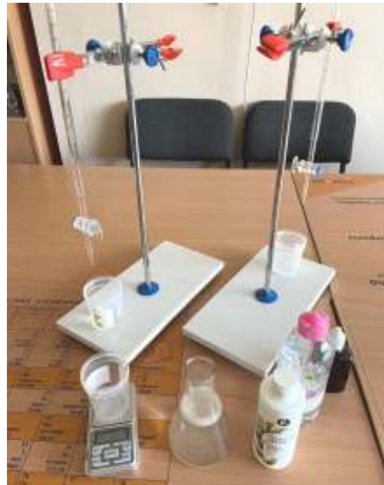
Рис. 1. Установа для визначення коефіцієнту поверхневого натягу лікарських речовин з антисептичними властивостями методом відриву крапель
