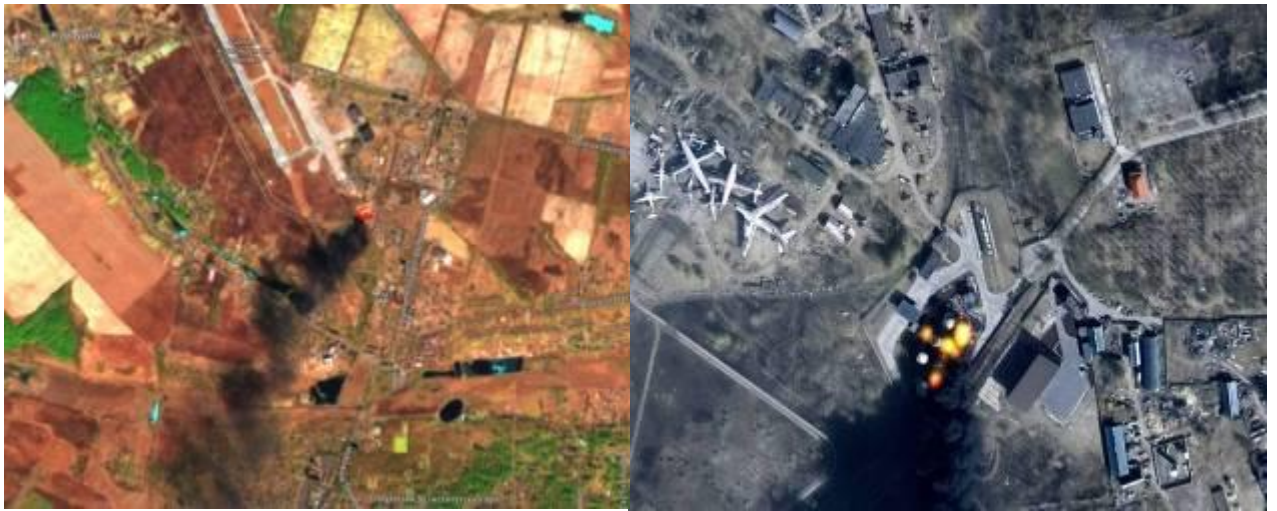
Рис. 3. Пожежа на нафтобазі с. Гостомель 11.03.2022 р.: а – відкриті дані ДЗЗ 10 м просторового розрізнення; б – комерційними дані ДЗЗ до 0,5 м просторового розрізнення.
