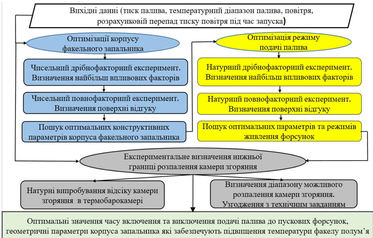
Рис. 1. Схема методики проектування факельних запальників ГТД
