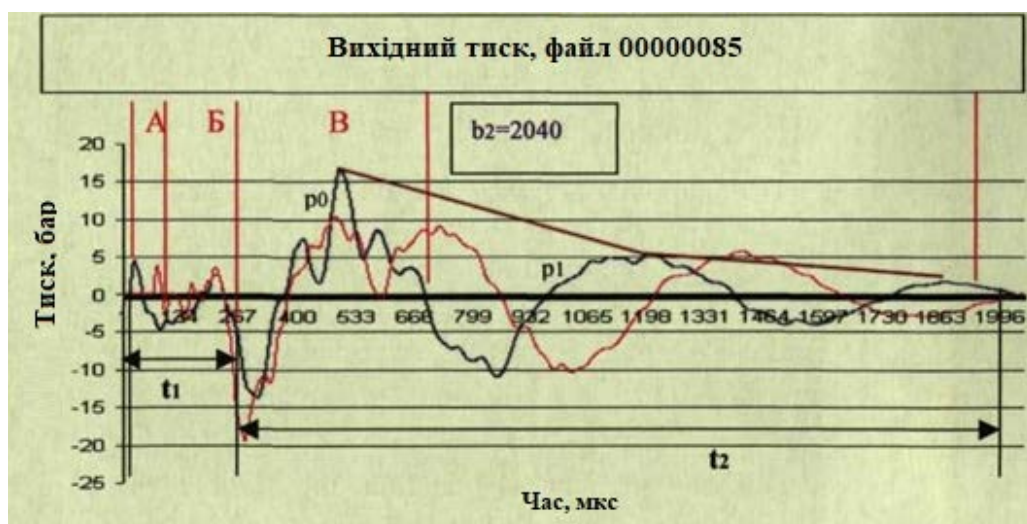
Рис. 1. Криві ХПД, що реєструються балістичними установками в тілі тварини при наскрізному пораненні живота кулею боеприпасу 7Н22, та етапи формування вогнепального поранення:
