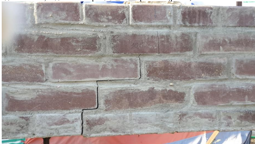
Рис. 8. образование нормальной трещины (образец Б-...)
