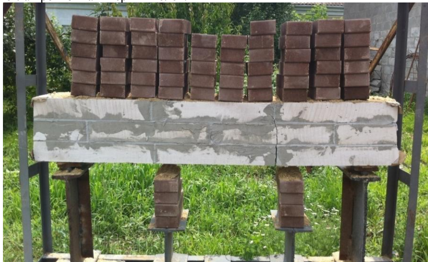
Рис. 5. Общий вид образования нормальной трещины
