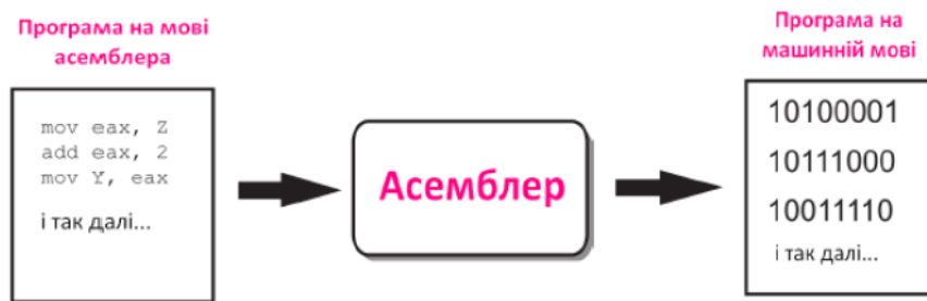
Рисунок 1.2.1. Схема роботи асемблера
