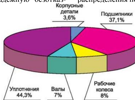
Рисунок 2. Диаграмма распределения повреждений по элементам насосов
