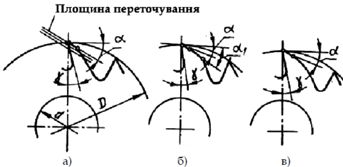
Рис. 2.60. Профілі зубів фрези а – звичайний; б - з ламаною спинкою; в – криволінійний
