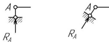
Рис. 1.3. Напрямок реакції R_A вздовж опорного стержня
