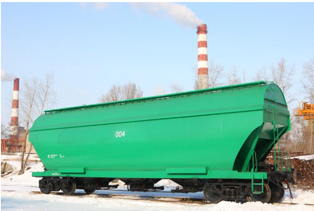
Рис. 1. Зерновоз нового покоління моделі 19-7053-02 (КВБЗ).
