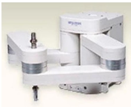
Рис. 2. Промислові роботи MELFA серії RP-ADH [4]
