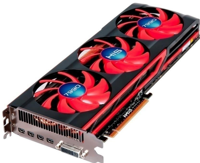
Рис. 1.38. Відеоадаптер з інтерфейсами 4 MiniDisplayPort, DVI
