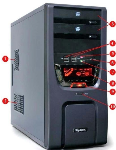
Рис. 1.25. Системний блок та основні отвори бокової та фронтальної панелі
