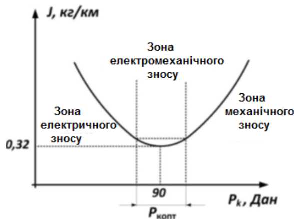
Рис. 2. Графік інтенсивності зношування контактної підвіски, що залежить від сили натискання струмоприймача, яка отримана під час статистичної обробки експериментальних дослідних даних
