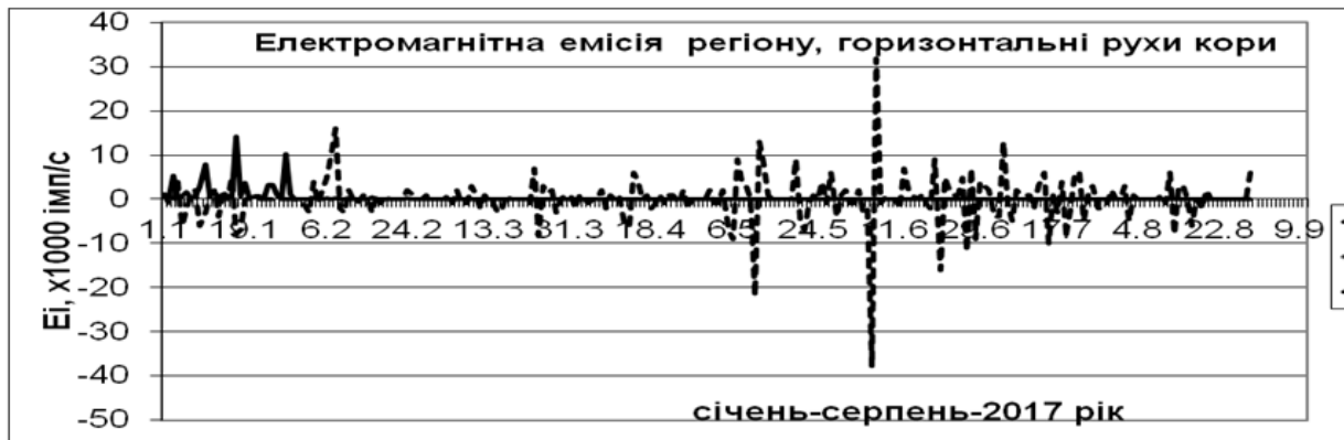
Рис. 1.1. Комплексний графік геофізичного моніторингу середовища в Закарпатському внутрішньому прогині за січень – серпень 2017 року: електромагнітна емісія в діапазоні 2 кГц (крива чорного кольору), рухи кори в зоні Оашського глибинного розлому (пунктирна лінія)
