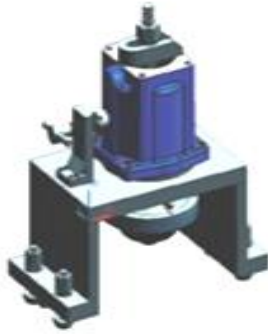
Рис. 7.6. Пристосування для обробки деталей «Корпус»
