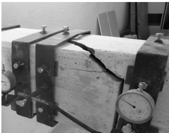
Рис. 7 Загальний вигляд руйнування зразка
