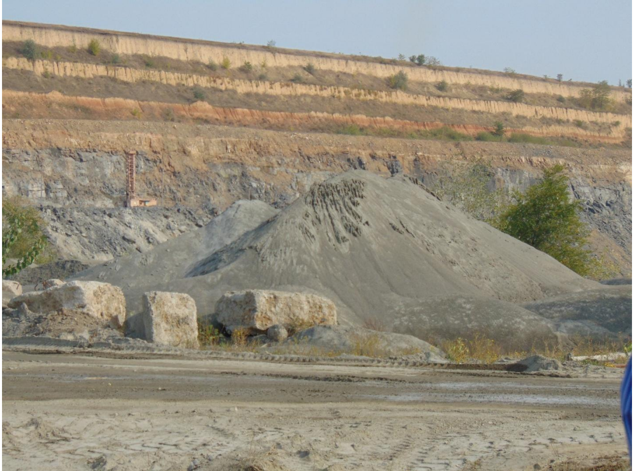
Рис. 6. Складування продукції на місці відпрацьованої ділянки, видно флювіальні форми рельєфу (ерозійні борозни) тимчасових водних потоків (на задньому плані розкриті на шарування осадових порід, кора вивітрювання)
